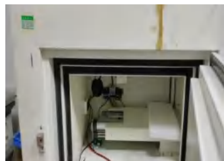
Fan noise test chamber
